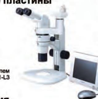
SMZ800 в комплекте со светоделителем P-IBSS2 S2, камерой DS-V1-L3
